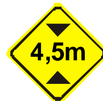
A - 37 ALTURA LIMITADA
