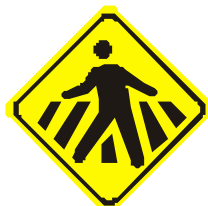
A - 32b PASSAGEM SINALIZADA DE PEDESTRES
